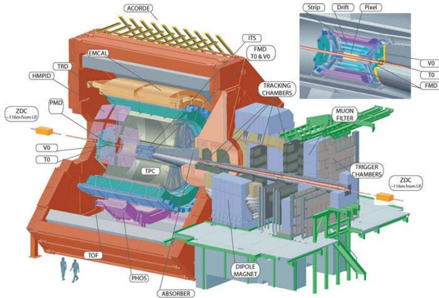
FIGURE 3: Schéma du détecteur ALICE.
