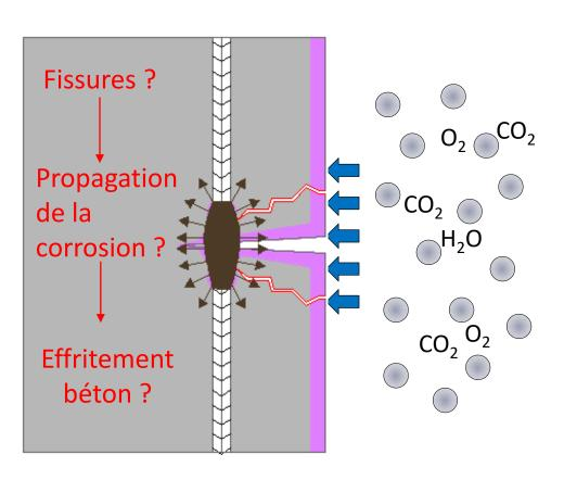
$Ca(OH)_2 + CO_2 \rightarrow CaCO_3 + H_2O$ Dépassivation de l'armature
