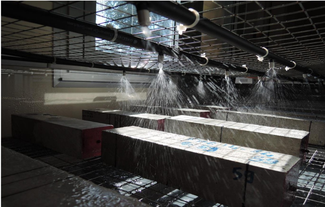
Figure 1: le dispositif ARIEL (simulating Rainfall for concrete durability) pour corrosion naturellement accélérée en laboratoire
