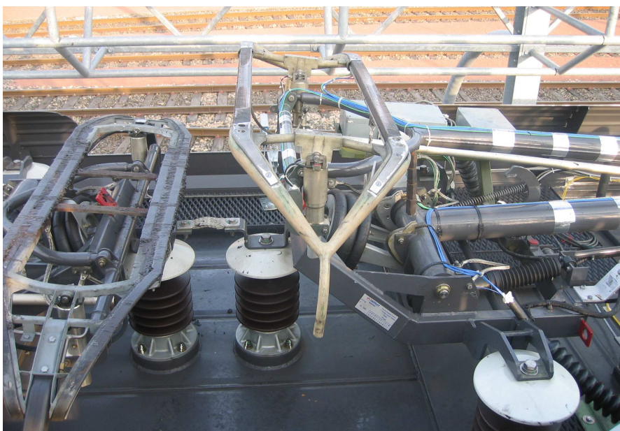
Figure 2: à droite, pantographe CX25 d'un TGV Duplex équipé de lignes de Capteurs à Fibres Optiques à réseaux de Bragg – Projet SMITS
