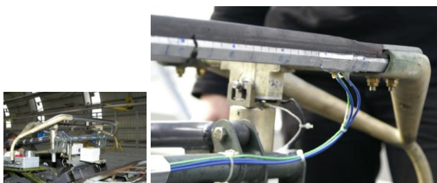
Figure 1. Pantographe instrumenté, avec vue de détail des câbles à fibre optique
