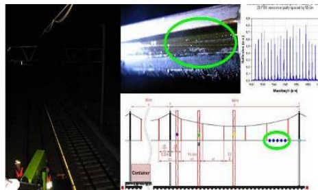
Figure 3: Ligne de 20 réseaux de Bragg multiplexés collée sur le fil de contact
