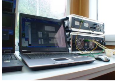
Figure 5. Système BraggFIT 3 surveillant le portique d'inspection
