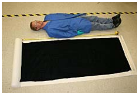
Figure 27 : Film de très grande surface à base de nanotubes dont la faisabilité a fait l'objet d'un communiqué de presse de la part de la société Nanocomp technologies. On notera la présence d'un employé seulement muni d'une blouse et d'une paire de gant au voisinage immédiat du film. Extrait avec la permission de ( http://www.nanocomptech.com/press/pr_02-22-08.htm ).
