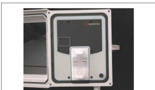
Figure 23 : Le prototype pré-production de Nanomix pour la détection de \text{NH}_3 en milieu avicole. Reproduit avec la permission de Nanomix.
