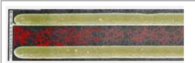
Figure 17 : Image de microscopie électronique à balayage (couleurs artificielles) d'un réseau 2D aléatoire de nanotubes (rouge) entre deux contacts métalliques d'or (jaune) obtenue à Nanomix en 2002. Extrait avec la permission de "Large Scale Production of Carbon Nanotube Transistors: A Generic Platforms for Chemical Sensors" ; J.-C. P. Gabriel : Mat. Res. Soc. Symp. Proc. 776, Q. 12. 7. 1 (2003).
