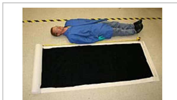
Figure 27 : Film de très grande surface à base de nanotubes dont la faisabilité a fait l'objet d'un communiqué de presse de la part de la société Nanocomp technologies. On notera la présence d'un employé seulement muni d'une blouse et d'une paire de gant au voisinage immédiat du film. Extrait avec la permission de ( http://www.nanocomptech.com/press/pr_02-22-08.htm ).
