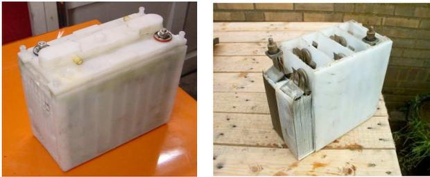
Figure 1 et 2: module of batterie Ni-Cd.
