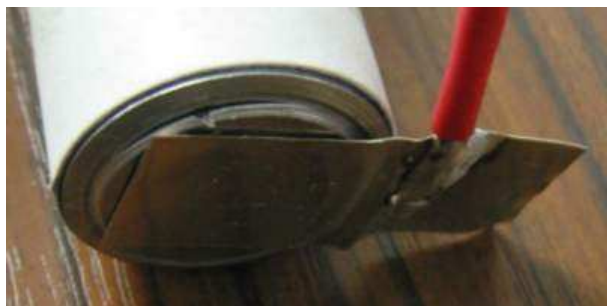
Figure 2 : Ouverture boîtier par surpression interne
