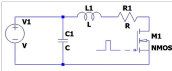
**Fig. 8:** Benchmark schematic
