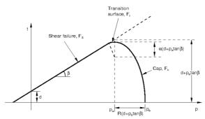
Fig 8: Drucker-Prager load surface
