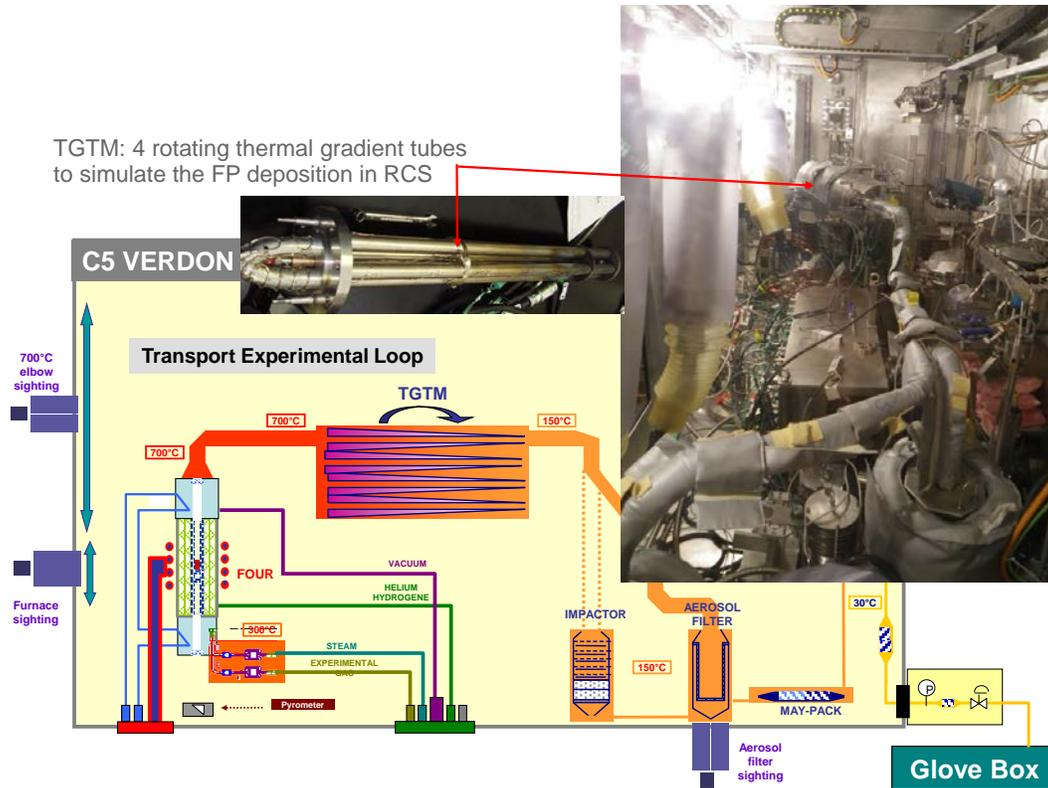
**Figure 3: The so-called transport experimental loop (CET)**
