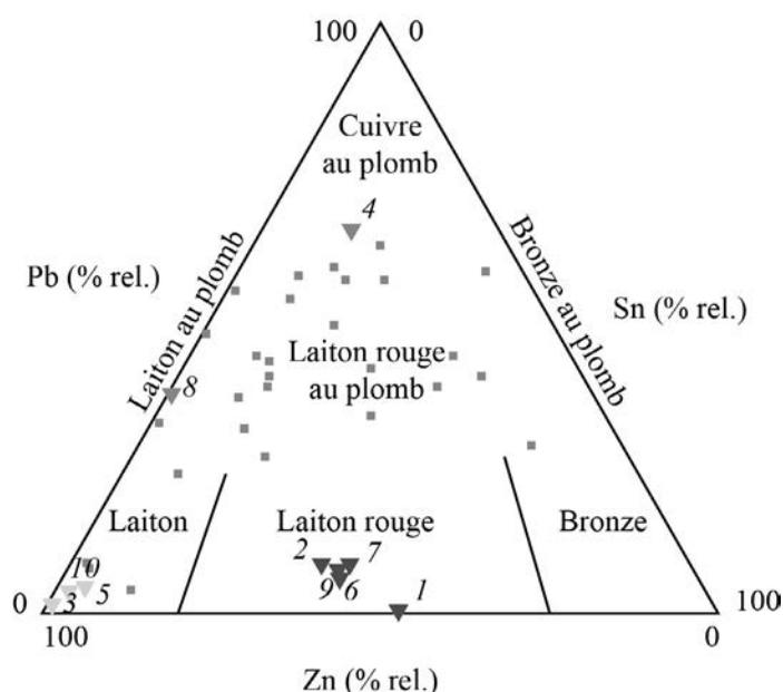
Figura 9. Distribution sur le diagramme ternaire des natures d'alliages employées (les triangles numérotés renvoient aux analyses, voir Figura 8 et 4 ; les carrés représentent les analyses des pommeaux faites par Dandridge et Wypyski en 2011).
