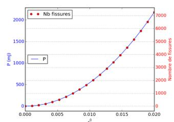
Détermination de la déformation de gaine nécessaire à la fragmentation totale du RIM
