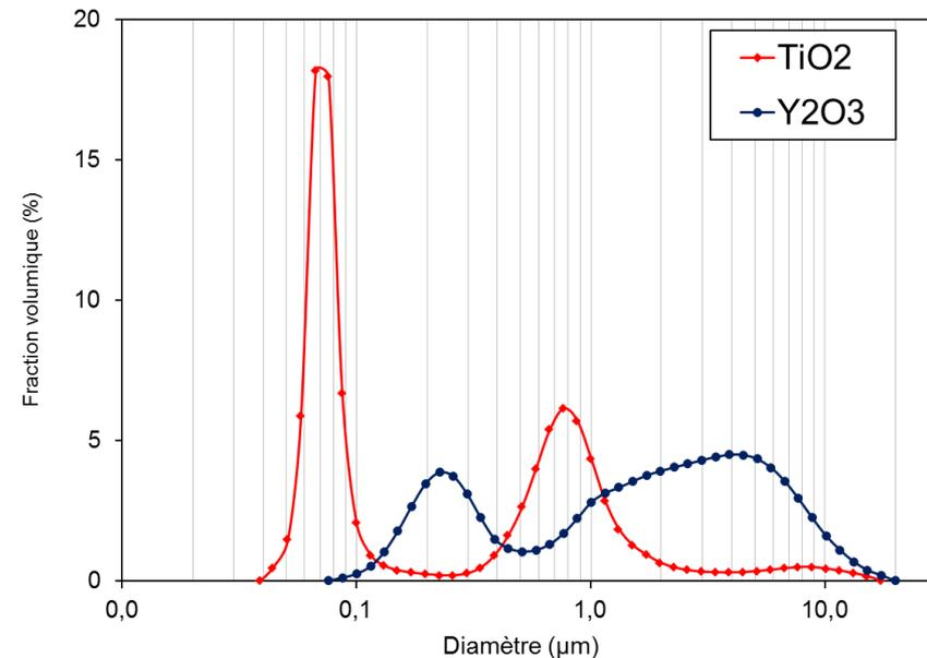
Les viscosités sont bien plus faibles que celles des suspensions pures aux mêmes taux de solides : effet de synergie des particules  $\text{TiO}_2 + \text{Y}_2\text{O}_3$  attribué aux distributions granulométriques complémentaires
