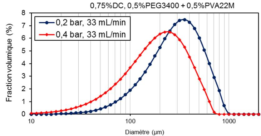
La taille moyenne des granules augmente quand : le débit de suspension augmente et/ou la pression d'air comprimé diminue
