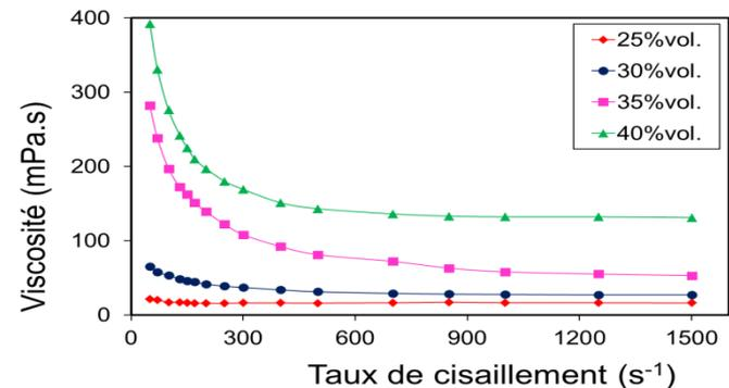
Le mélange de poudres permet de monter à des taux de solides supérieurs à ceux des suspensions de poudres pures :
