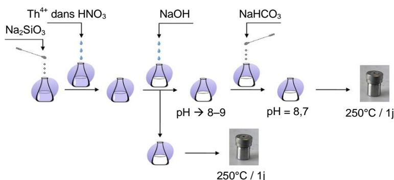
Figure 1. Protocole de synthèse de ThSiO<sub>4</sub> en présence et en absence d'ions carbonate
