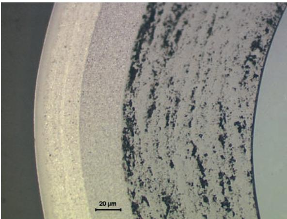
Fig. 72. Coupe d'un dépôt de ZrC réalisé au CEA sur des noyaux simulants, à base de zircone enrobée dans du pyrocarbone.
