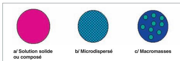
Fig. 31. Morphologies des différents combustibles à matrice inerte.
