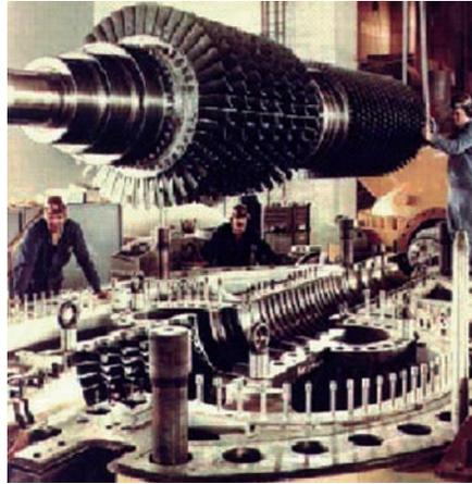
Fig. 77. L'étage haute pression de la turbomachine de 50 MWe de la centrale à gaz expérimentale d'Oberhausen II, en Allemagne (hélium à 750 °C). On remarque, en particulier, la petitesse des pales du second étage due à la faible densité de l'hélium.
