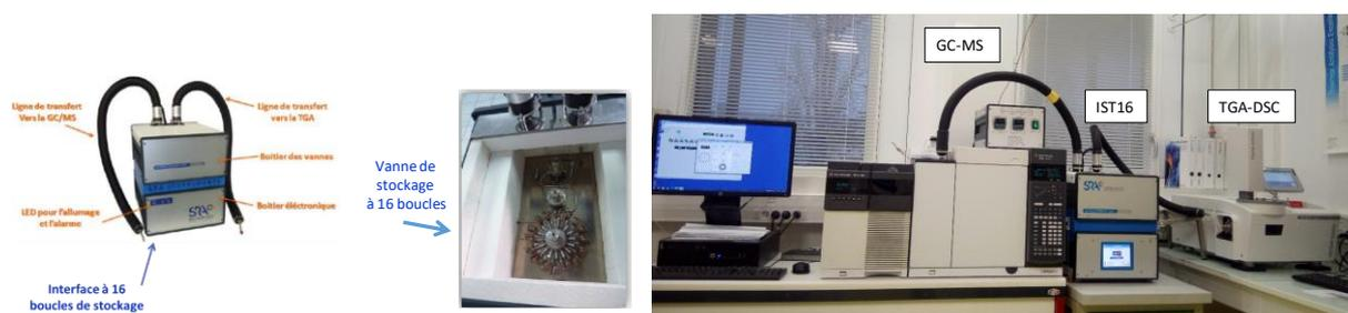
Figure 28 : Dispositif du couplage ATG-DSC/IST/GC-MS
