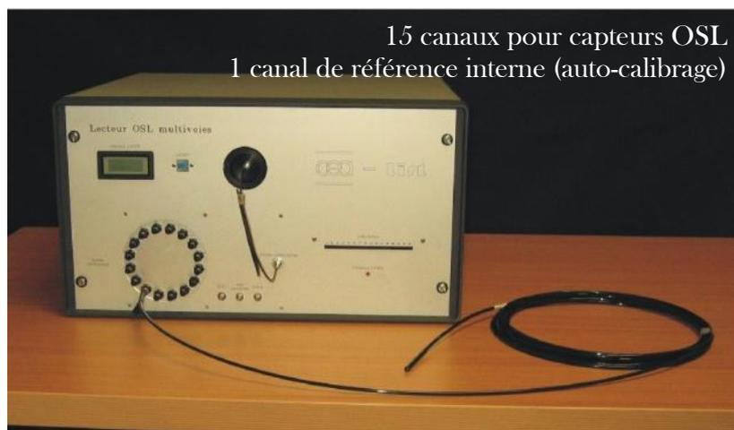
Figure 2. 30 : Instrumentation OSL multivoies pour fibres optiques
