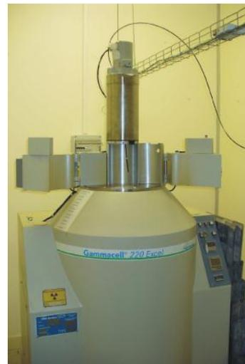
Figure 2. 18 : Irradiateur *Gamma-cell* (60Co) du CEA-LNHB
