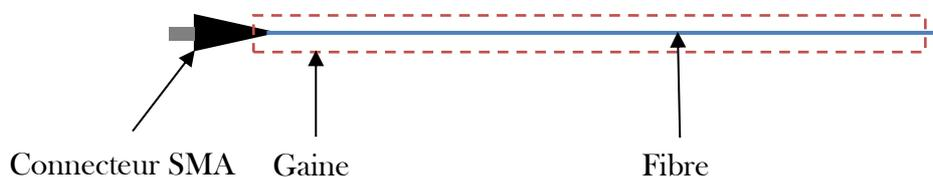
Figure 2. 10 : Gainage de la fibre
