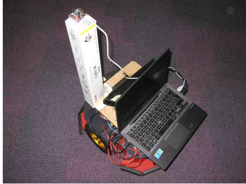
**Figure 10** – Le robot pioneer 3 équipé avec une Kinect 1 et un magnétomètre MEMS. Le magnétomètre est monté sur une longue boîte en carton pour éviter les interférences magnétiques avec la structure métallique du robot.
