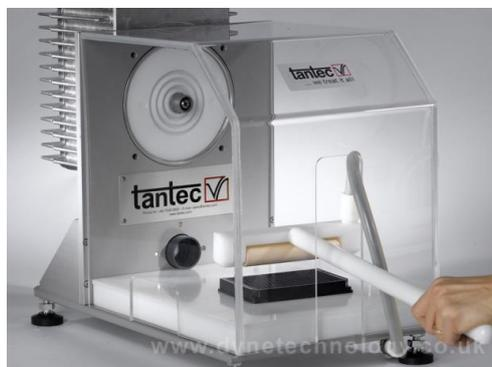
Figure 35 : Dispositif expérimental utilisé pour le traitement Corona.
