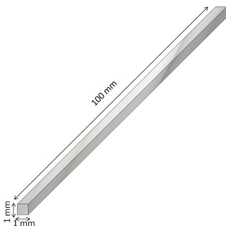
(a) Dimensions caractéristiques du barreau réalisé à partir de l'échantillon de FeNi36.
