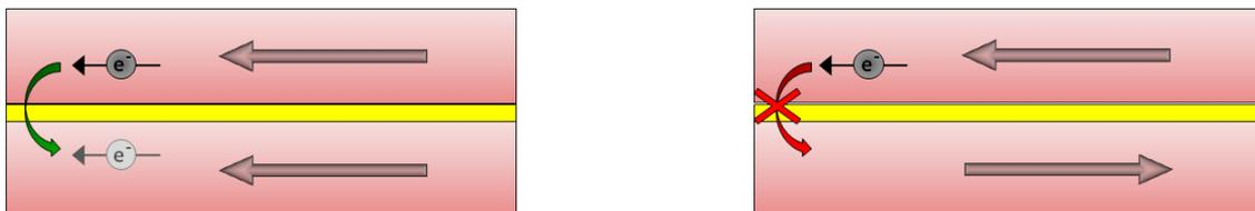
(a) Configuration parallèle dans laquelle l'électron avec un spin aligné possède une haute probabilité de traverser la barrière isolante par effet tunnel.
