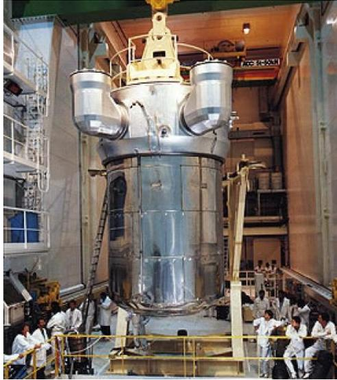
FIGURE 3.43: Photographie d'une cuve d'un réacteur nucléaire constituée d'acier (©Istockphotos).
