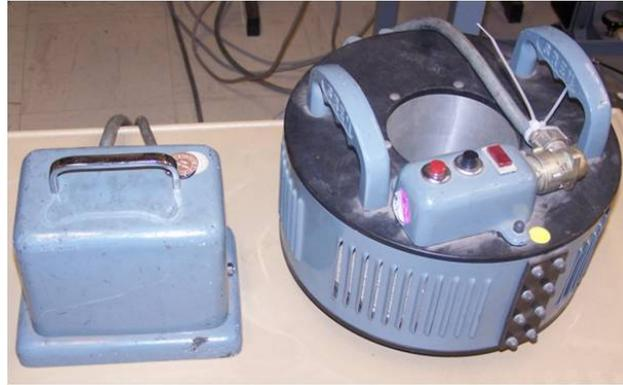
FIGURE 3.45: Photographie de l'appareil utilisé pour démagnétiser la plaque.
