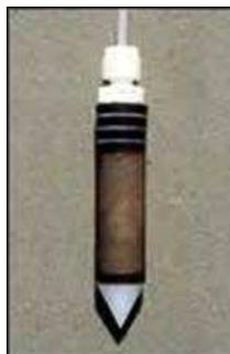
**Photographie 6 : Lysimètre PRENART© en PTFE/quartz (diamètre 21 mm ; longueur 95 mm ; taille de pore 2 µm).**
