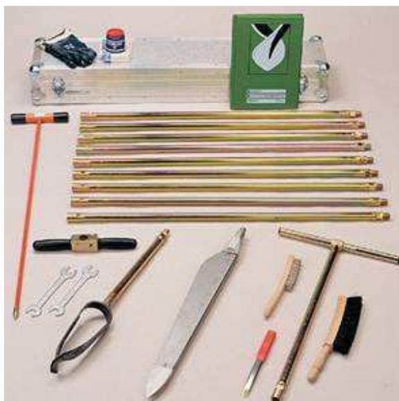
**Photographie 9 : Set de tarières en acier traité (tarière Edelman à gauche et tarière « russe » en forme de cylindre à droite), utilisé lors des prélèvements de sol manuels (SDEC France-Eijkelpamp). La tarière « russe » fait 0,5 m de longueur, 60/52 mm de diamètre extérieur/intérieur et 0,5 L de volume.**
