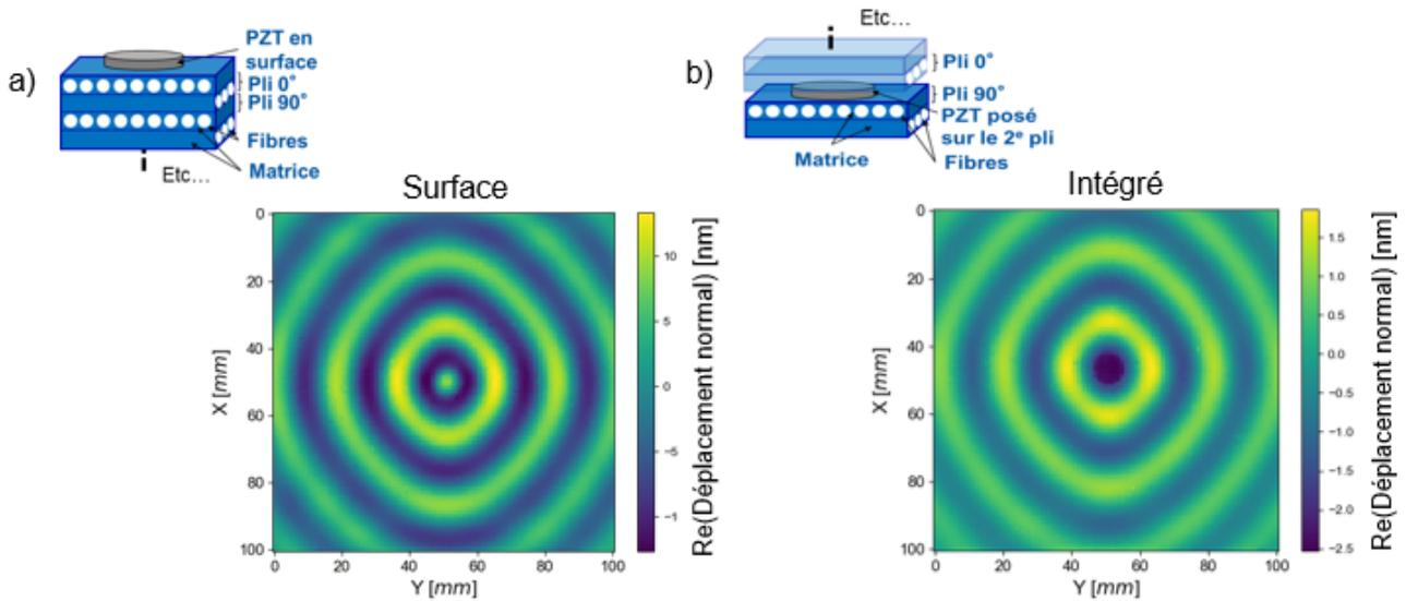
**Figure 2 :** Déplacement normal au plan de la plaque composite, mesuré par vibrométrie laser par émission d'ondes générées à 50 kHz pour le cas a) d'un PZT collé en surface et b) d'un PZT intégré entre deux plis de composite
