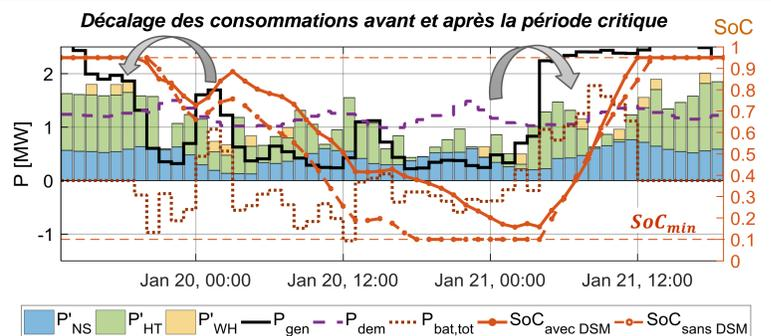
Dimensionnement considéré : PV : 0,8 MW, éoliennes : 1,62 MW, hydroliennes : 2,4 MW, houlogénérateurs : 0,87 MW, batteries : 12 MWh
